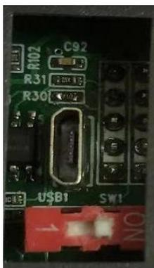
打开D930模块的正面翻盖，会看到有一个拨码和一个micro usb接口。拨码两个档位，拨到ON位置5S后会进入模块参数配置状态，拨到1位置模块正常通讯状态。
