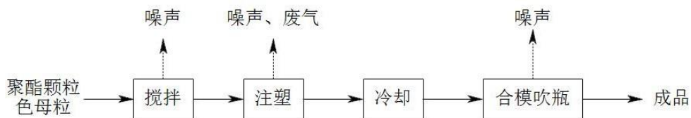
图 2-12 聚酯容器生产工艺流程及产污环节图
