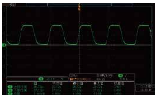
IT8906A-1200-240 5kHz动态加载0A-50A
