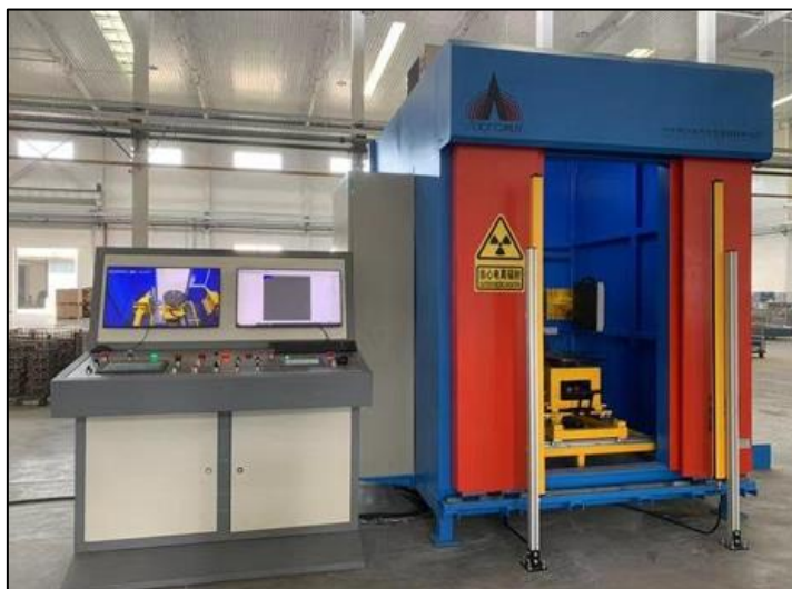
图 9-1 X 射线数字成像检测系统示意图
