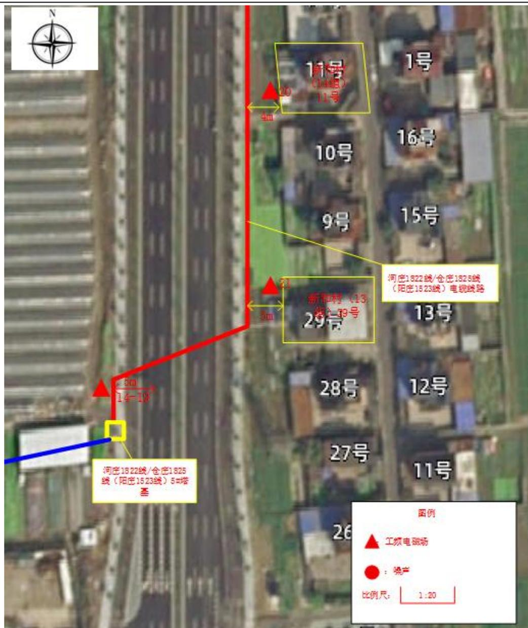
图 7-3 青西三路(江东一路-塘新线北侧)段现状 110 千伏义白、义庄架空线路上改下工程工频电磁场及噪声监测布点
