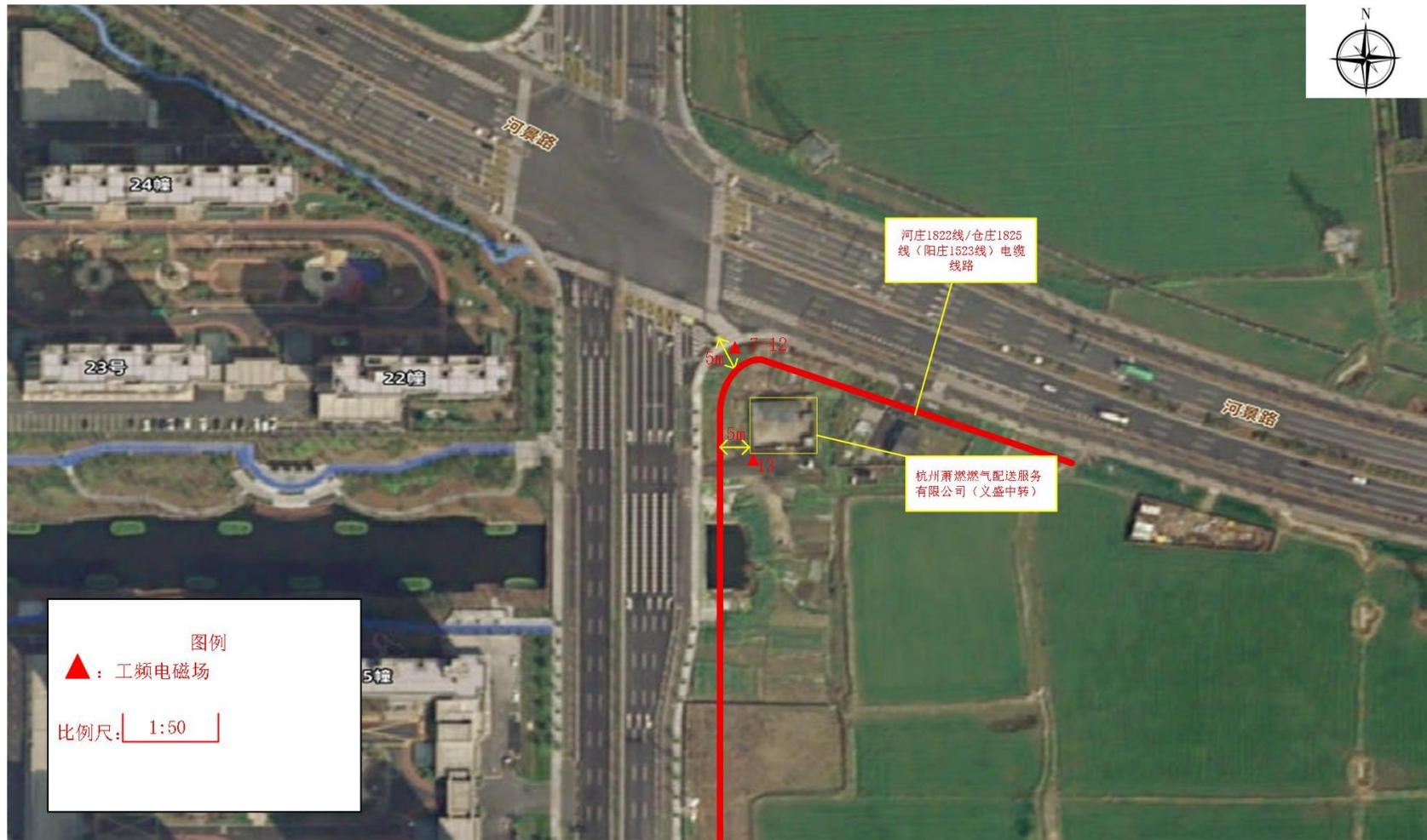
图 7-2 青西三路(江东一路-塘新线北侧)段现状 110 千伏义白、义庄架空线路上改下工程工频电磁场及噪声监测布点
