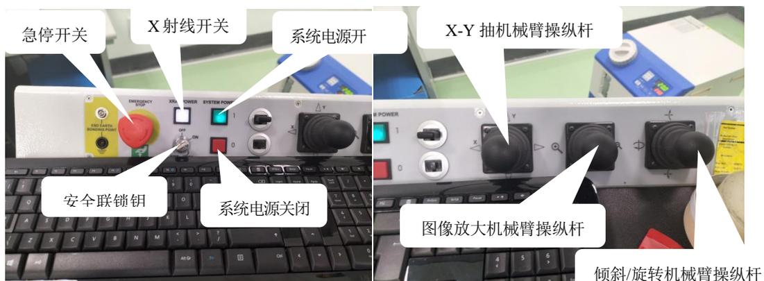
图 8-9 工业 CT 机控制台防护落实情况
