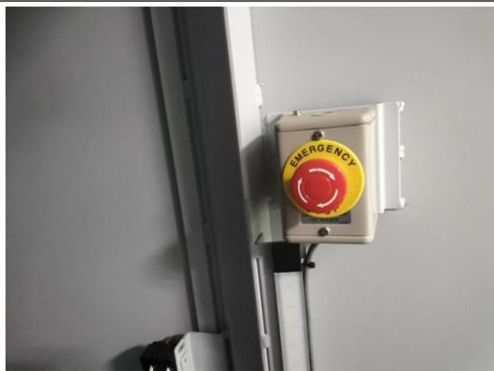
图 8-3 X 射线实时检测装置内急停按钮
