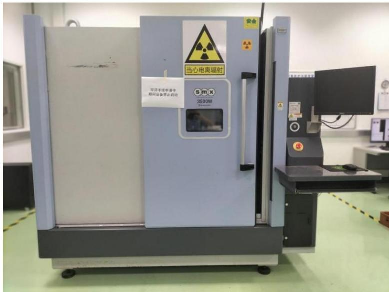
图 2-9 本项目 X 射线实时成像检测装置实物图
