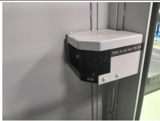
图 8-4 X 射线实时检测装置门-机联锁装置
