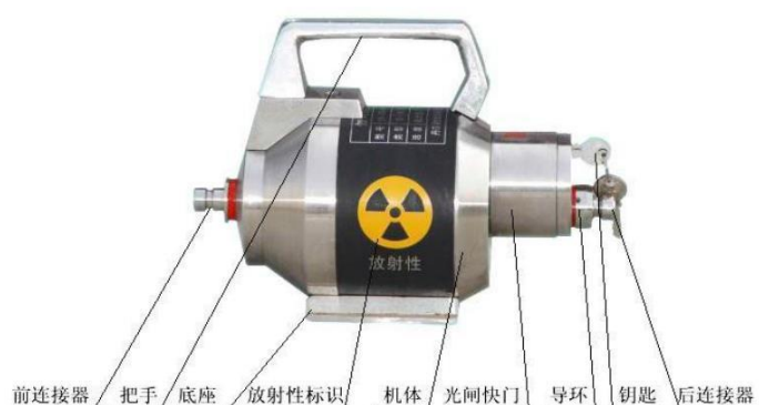
图9-1 源屏蔽容器（贮源容器）外部结构组成图
