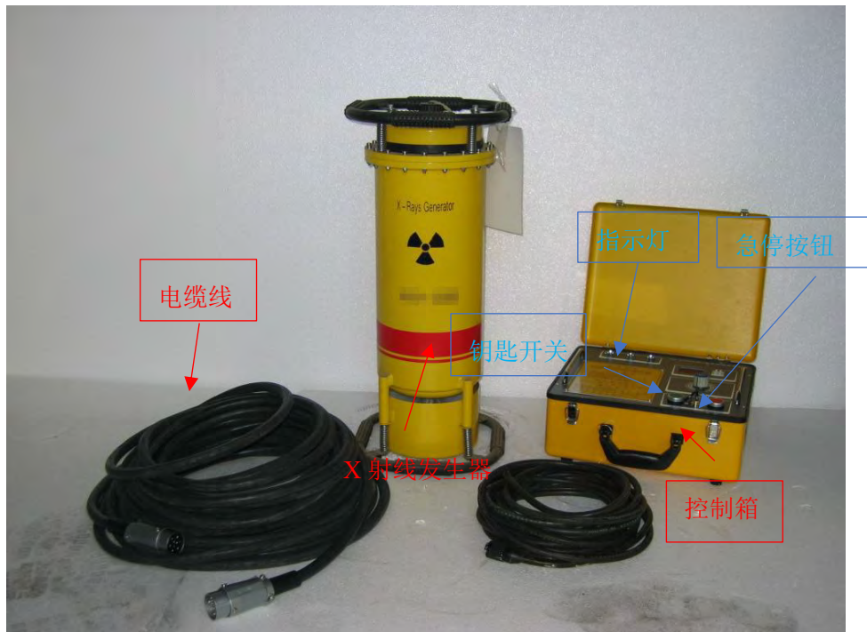
图 2-4 探伤装置设备构造图
