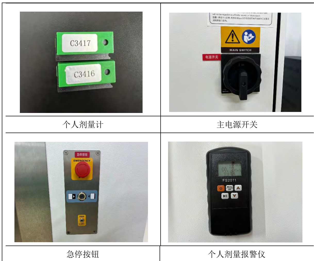
图 4-1 辐射安全与防护设施实物图
