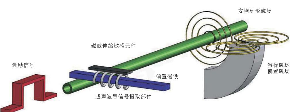
以光速在波导材料周围形成周向的安培环形脉冲磁场，该环形磁场与游标磁环的偏置永磁磁场发生耦合时，会在波导材料表面形成魏德曼效应扭转应力波（本征速率约2800m/s），由产生点向波导丝的两端传播，传向末端的扭转波被阻尼器件吸收，传向激励端的信号则被检波装置接收，电子仓中的控制模块计算出查询脉冲与接收信号间的时间差，再乘以其本征速率即可计算出扭转波发生位置与测量基准点间的距离，也即游标磁环在该瞬时相对于测量基准点间的绝对距离，从而实现对游标磁环位置的实时精确测量。
