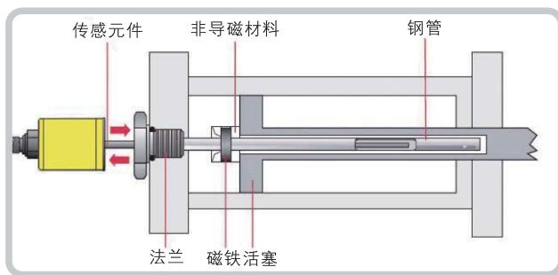
**AMT**系列内置式位移传感器采用了一体化设计，传感器内置集成于液压油缸内，安装在活塞上的游标磁环随活塞一起沿传感器耐压管轴向运动，由于游标磁环内壁与耐压管外壁有2毫米左右的间隙，因此其运动和测量都是无摩擦的。
